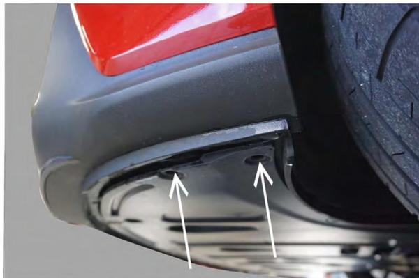
Die beiden Befestigungen am Unterfahrerschutz lösen
