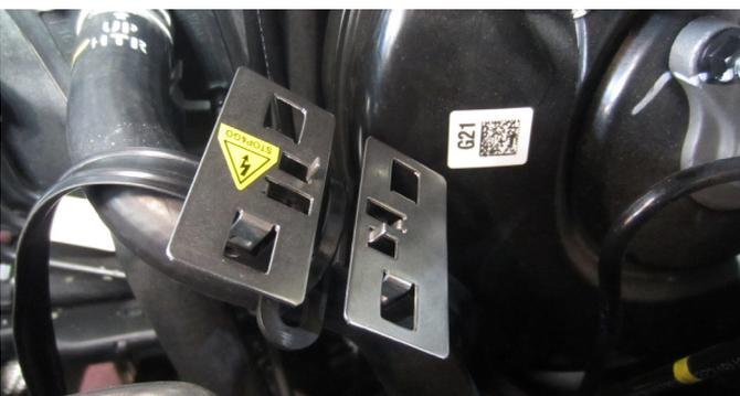
Die vierte Kontaktplatte mit Kabelbindern am Wasserschlauch unten beim Wärmetauscher befestigen.
