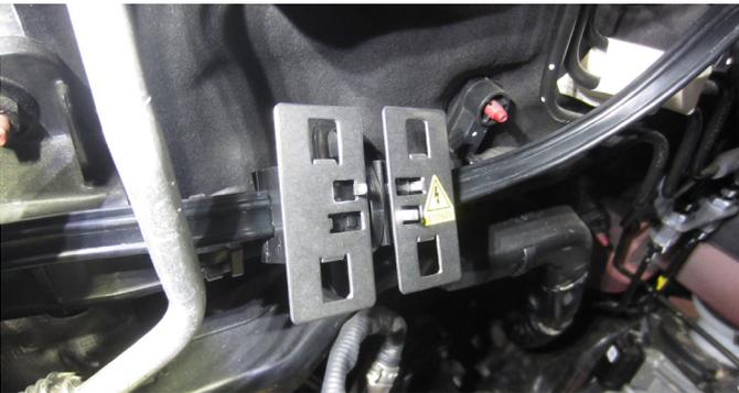
Die dritte Kontaktplatte am Kabelstrang der Spritzwand mit Kabelbindern befestigen.
