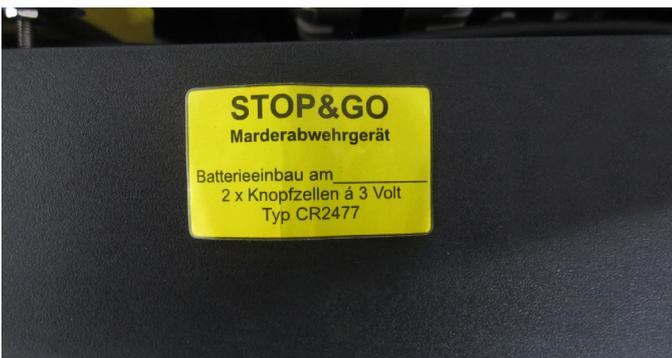
Bringen Sie auch den ausgefüllten gelben Aufkleber für den Batteriewechsel gut sichtbar im Motorraum an.
