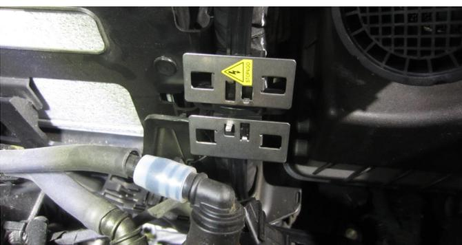
Die fünfte Kontaktplatte am Kabelstang des ECU neben der Batterie mit Kabelbindern befestigen.
