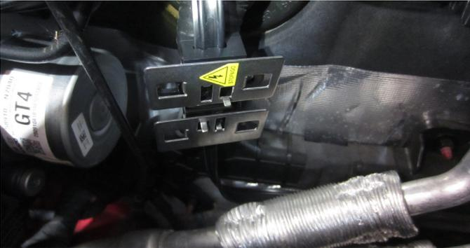
Die zweite Kontaktplatte bei dem ABS-Block Kabelstrang mit Kabelbinder befestigen.
