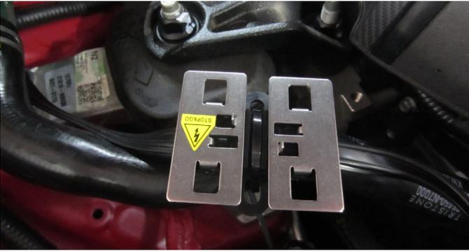
Die erste Kontaktplatte mit Kabelbinder an dem Wasserschlauf des Kühlwasserbehälter befestigen.
