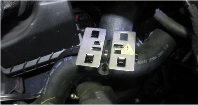
Die letzte Kontaktplatte an den Wasserschlauch oben links beim Motorkühler mit Kabelbinder befestigen. Kabelüberstand abschneiden.
