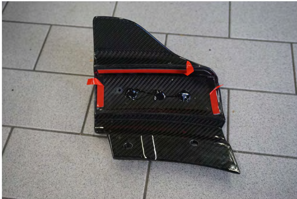
Die Trennfolie des Klebebands an den Ansätzen lösen und drei Haselnussgroße Klebertropfen vom mitgelieferten Kleber in der Innenfläche anbringen.
