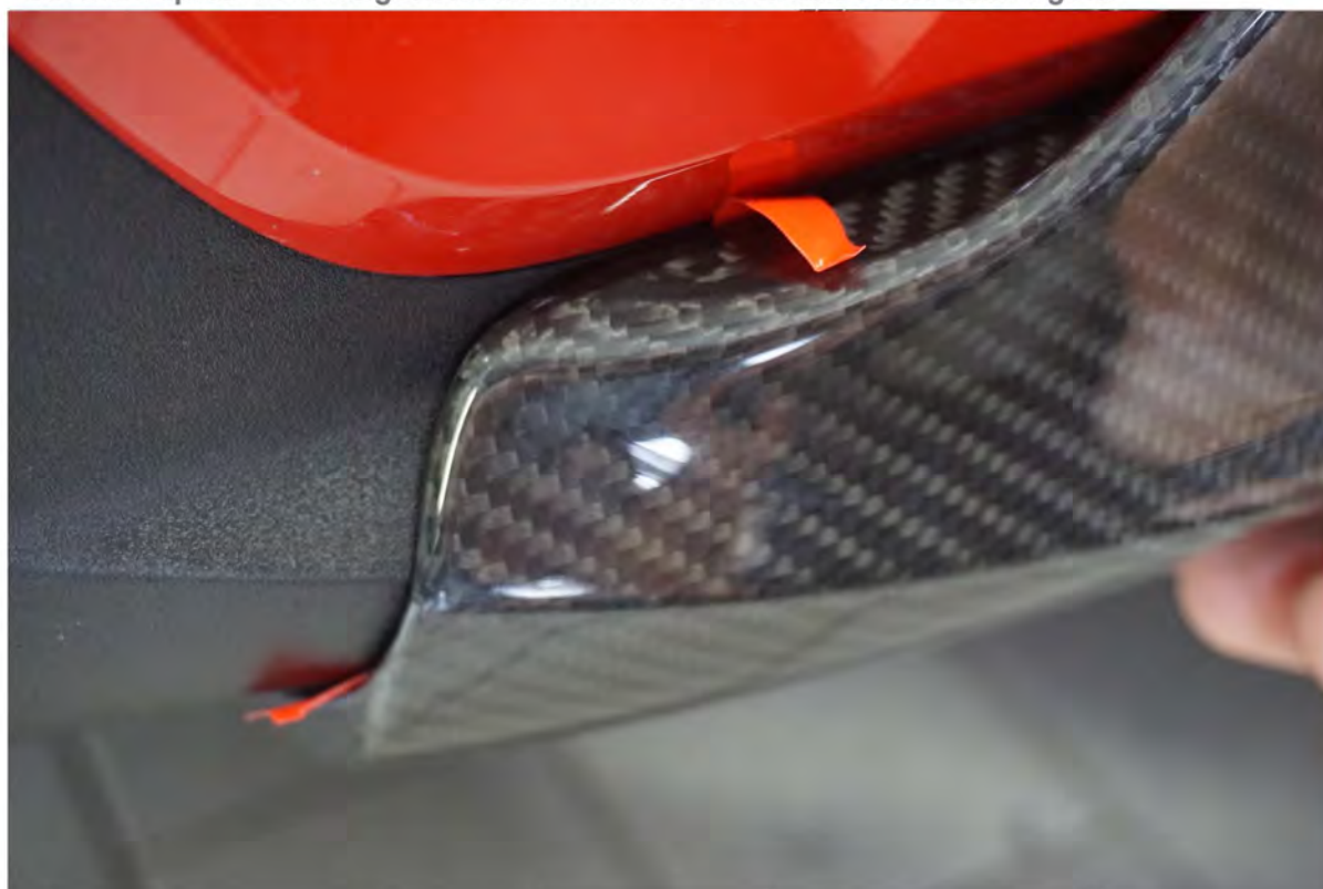
Den flap am Fahrzeug bündig mit der Radlaufkante in position bringen und festdrücken. Vorsichtig die Trennfolienstreifen herausziehen. Nochmals festdrücken.
