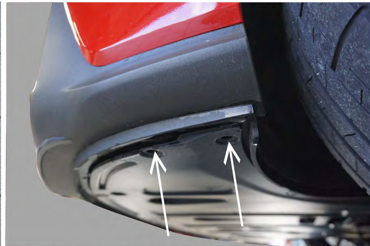
Die beiden Befestigungen am Unterschutz lösen
