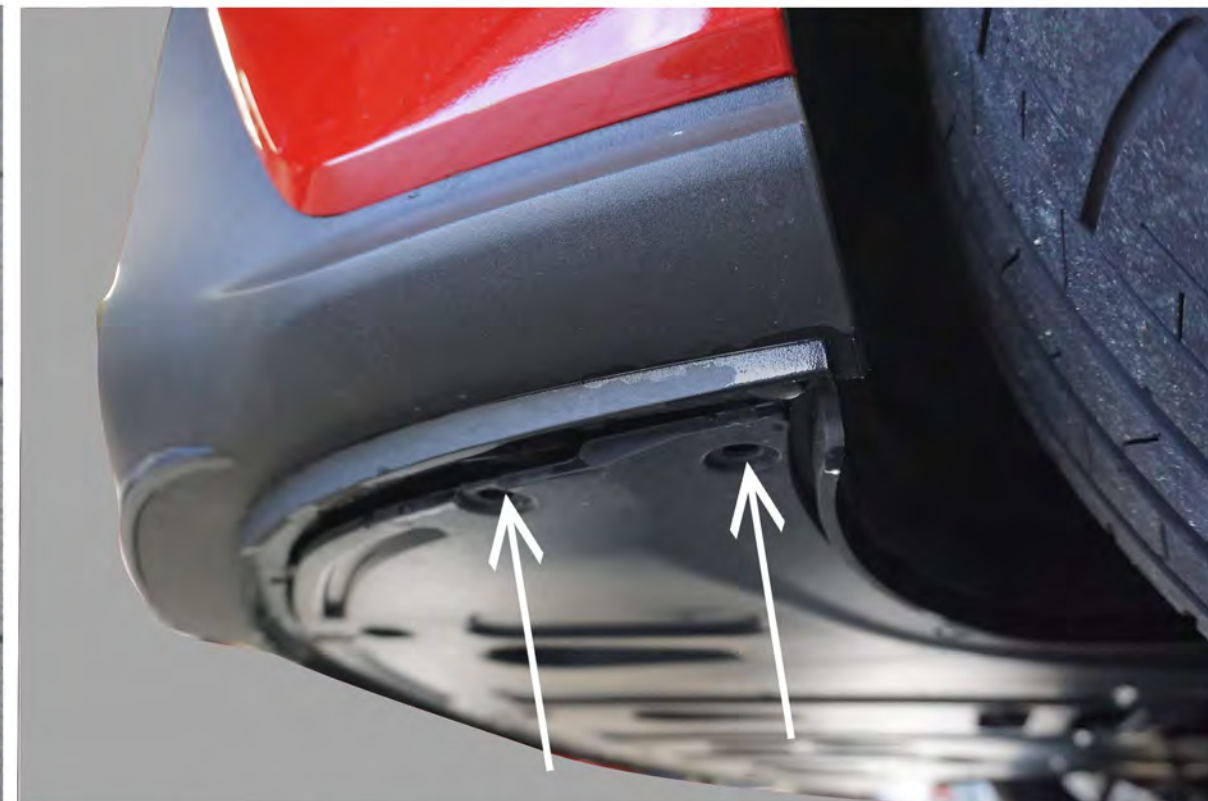
Die beiden Befestigungen am Unterfahrerschutz lösen
