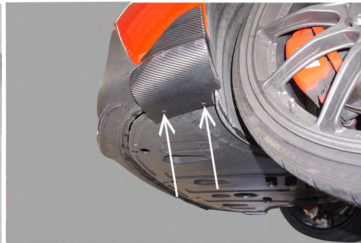
Rad einschlagen Radhauschale lösen im Bereich des Carbonflaps. Mitgelieferte M5 Schrauben von unten durchführen und von innen mit Beilagscheiben und Muttern kontern.
